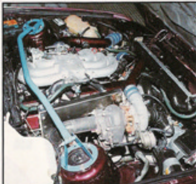
SWEDISH POWER. Den 6-cylindriga motorn har försetts med en Garrett TB3 turbo, laddluftkylare och PIC3 bränsledator från GIK Turboteknik i Göteborg. Laddtrycket är justerbart från kupén. Bilen är också utrustad med en oljekylare från Setrab i Malmö.
